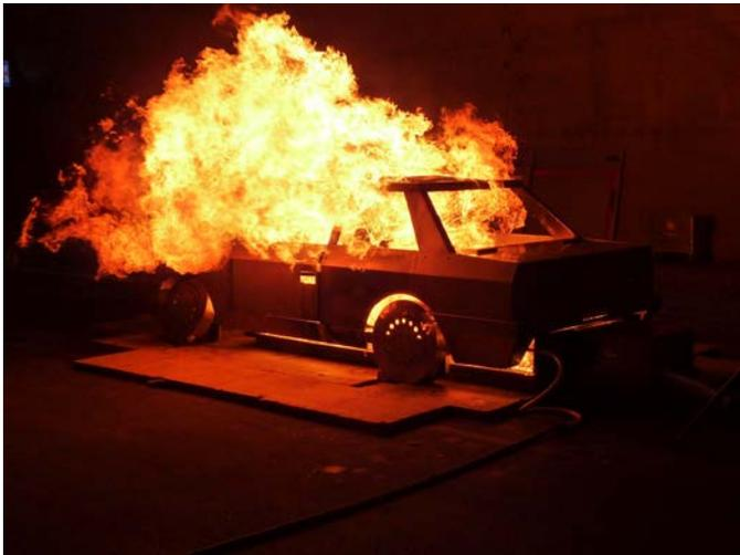
**Bildunterschrift:** Für die Brandversuche kommt eine mit Flüssiggas befeuerte PKW-Attrappe zum Einsatz.
