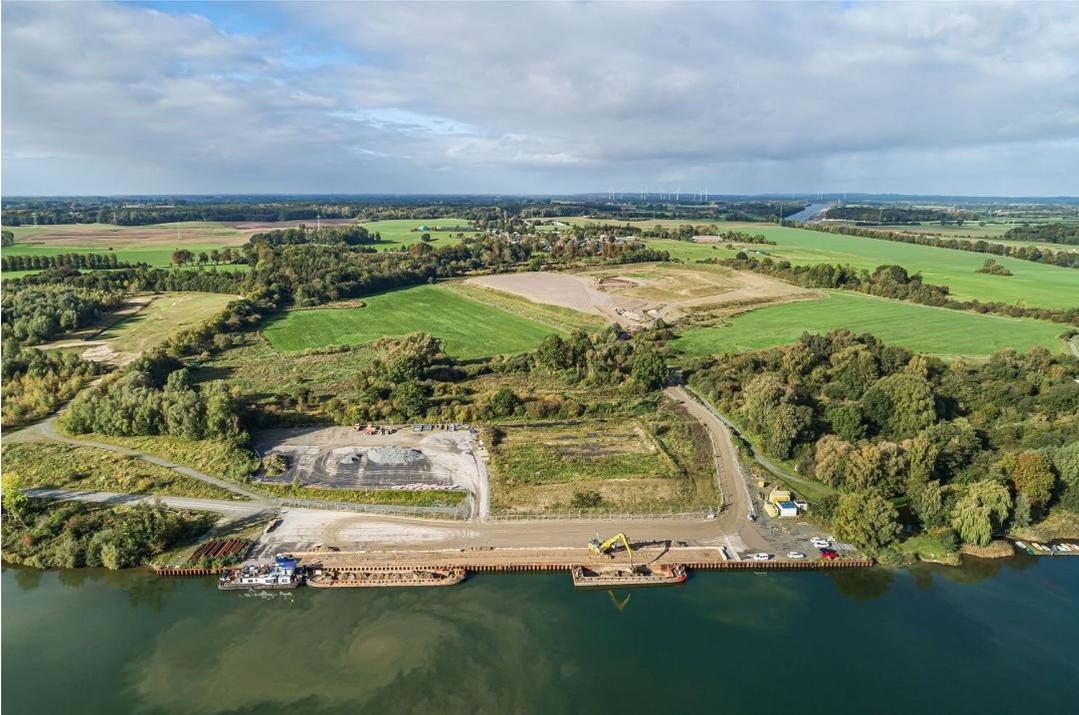
*Von der Baustelleneinrichtungsfläche Flemhude werden die Steine für das neue Deckwerk transportiert.*
