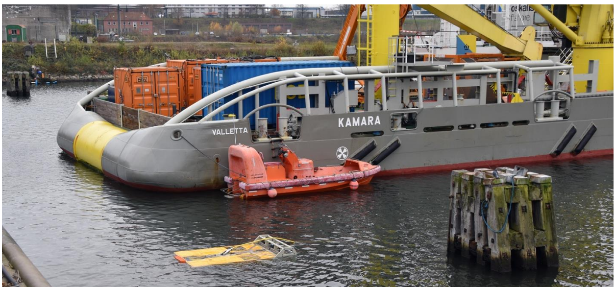
Sondierung unter Wasser mithilfe eines Tauchroboters
